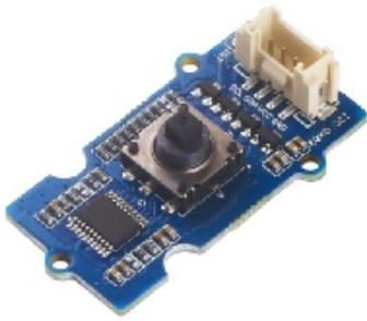
4. Une manette est un capteur. Elle permet d'appuyer sur une des 4 directions ou au milieu
