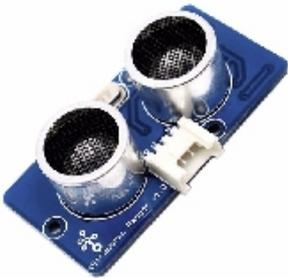
6. Un capteur émetteur-récepteur à ultrasons permet de mesurer la distance.
