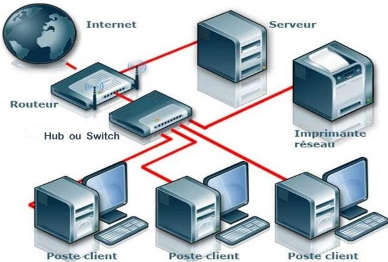
40) On suppose qu'un des postes clients envoie sur le réseau une requête vers l'adresse IP du Routeur.
